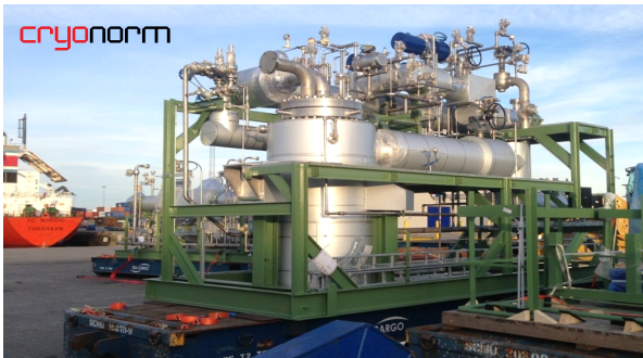
LNG PUMP SKID
